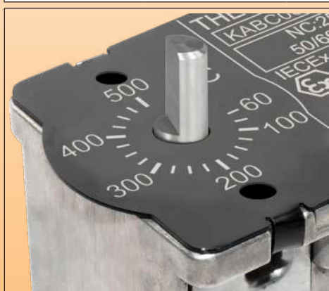
A : Axe de longueur 10mm et de diamètre 6mm avec méplat, pour utilisation avec manette imprimée et enjoliveur ou petite manette flèche (disponibles en accessoires ci-dessous) ;
